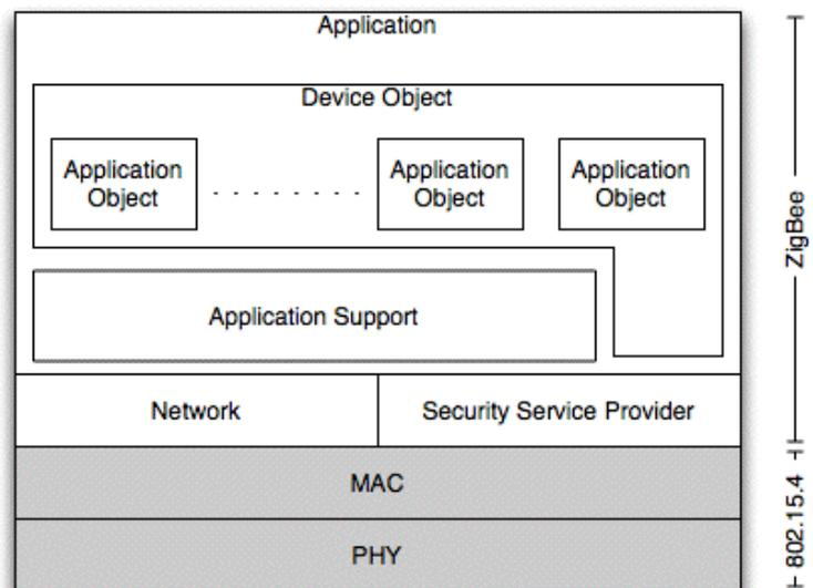
Fig. 4 ZigBee Protocol stack
