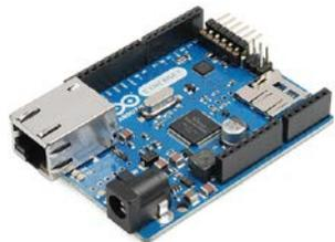
Fig. 3. Ethernet Module
