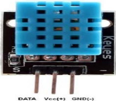
Figure (2) DHT11 sensor
