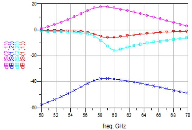
Fig.7 S-parameters of the proposed LNA: S21(O) ; S11(Δ) ; S22(□); S12(x).
